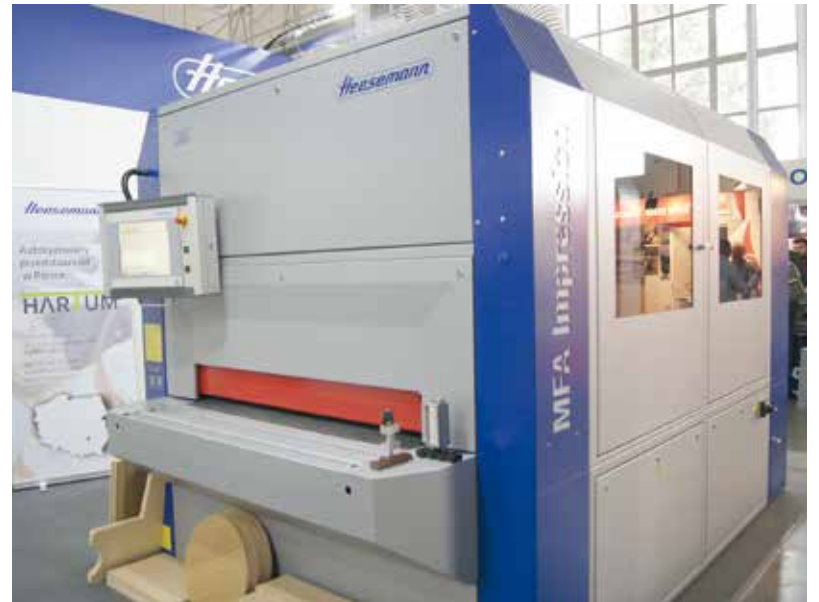
HEESEMANN stworzyła sterowaną komputerowo selektywną regulację docisku o symbolu CSD, czyli elektromagnetyczną belkę docisku, która pozwala na płynną regulację docisku szlifowania pojedynczych segmentów belki dociskowej w ciągu kilku milisekund. Fot. Alicja Bagnucka
